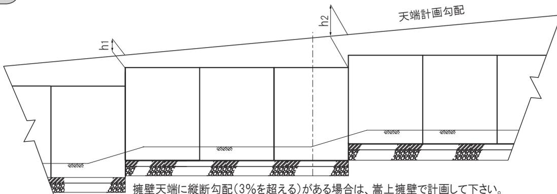
擁壁天端に縦断勾配(3%を超える)がある場合は、嵩上擁壁で計画して下さい。
