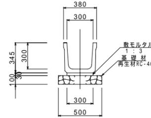
鉄筋コンクリートU形（水路用KW）数量表 10m当り
