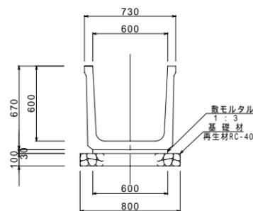
鉄筋コンクリートU形（水路用KW）数量表 10m当り
