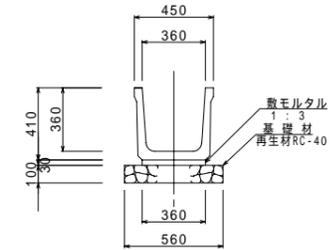
鉄筋コンクリートU形（水路用KW）数量表 10m当り
